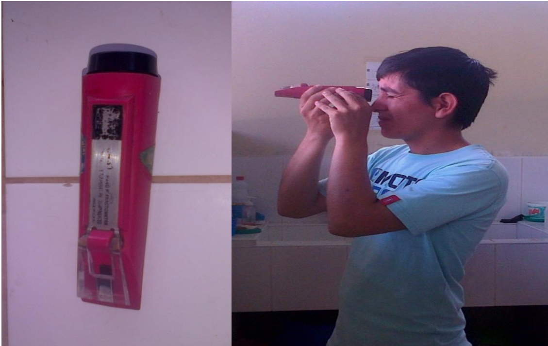
Figura 16. Brixómetro manual (izquierda); lectura de sólidos solubles (derecha)
