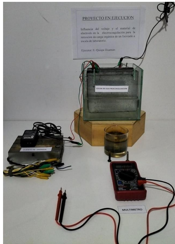
Figura 8. Pruebas preliminares para la implementación del sistema de electrocoagulación de la investigación.
