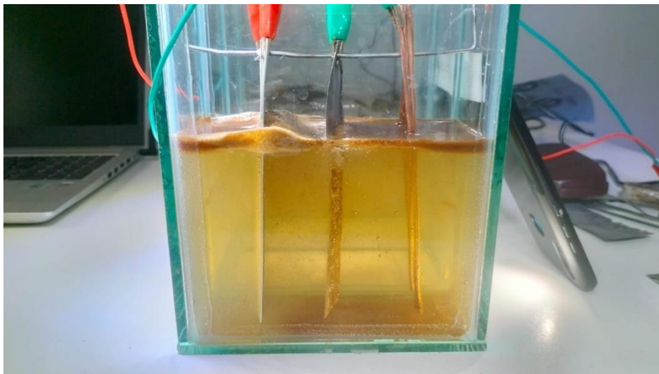
Figura 13. Tratamiento de lixiviado con electrocoagulación a 20 voltios
