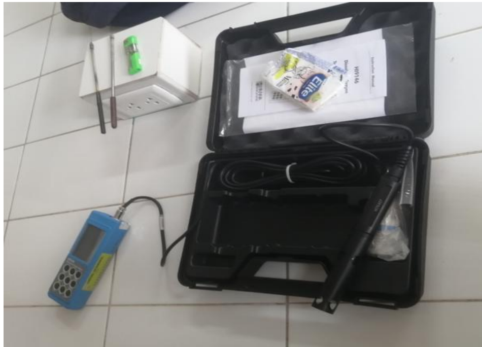
Figura 52. Medición de parámetro Oxígeno Disuelto
