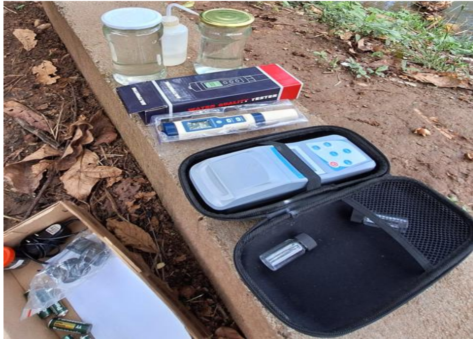
Figura 48. Toma de datos en campo con equipo Turbidímetro, para turbidez
