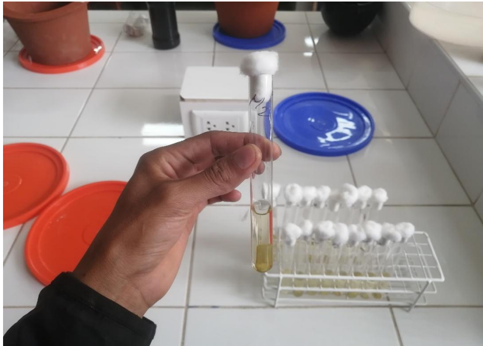
Figura 56. Determinación de Coliformes totales NMP/100 ml, muestra M1-2 y M2-2 (sin presencia).
