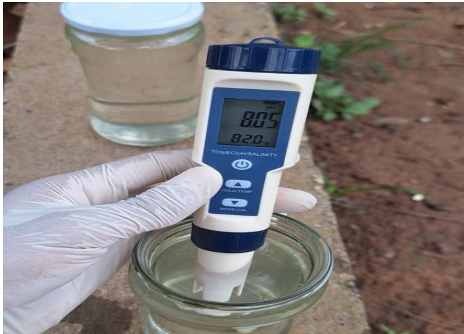
Figura 47. Toma de datos en campo con equipo multiparámetro, para pH.
