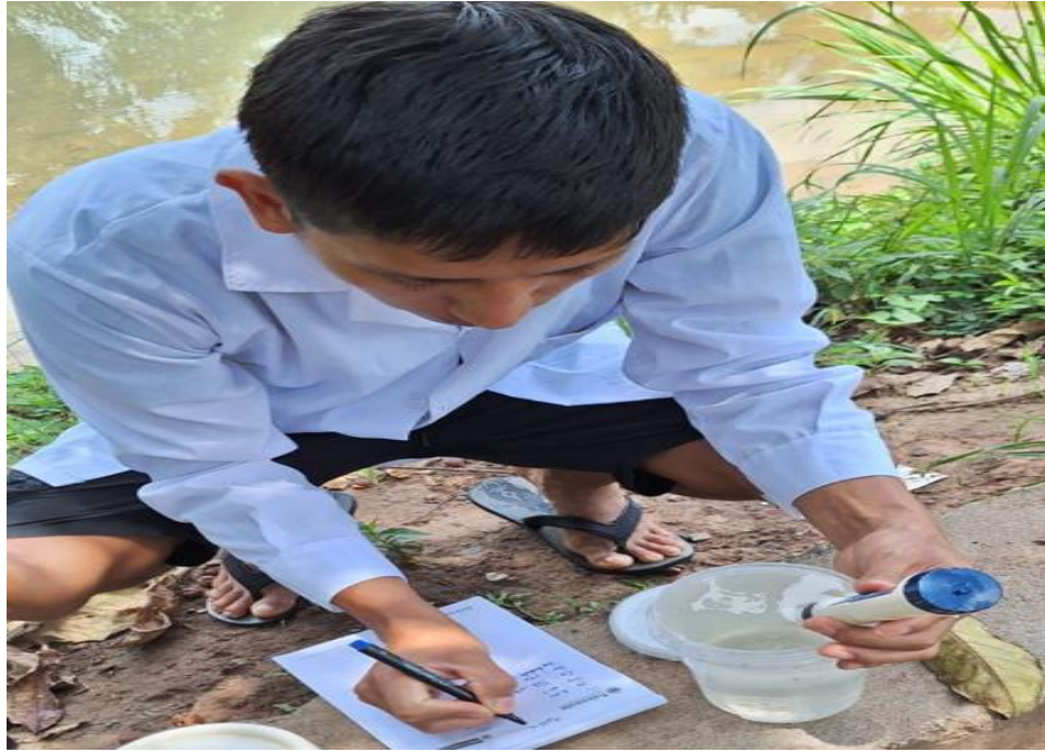
Figura 46. Toma de datos en campo con equipo multiparámetro, para pH, SDT y °T.
