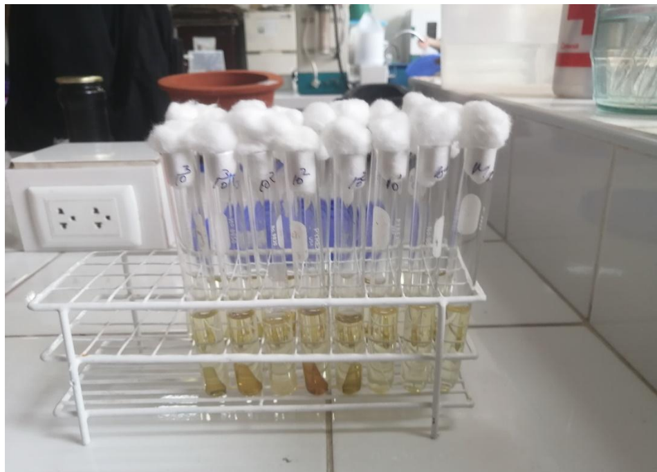
Figura 56. Determinación de Coliformes totales NMP/100 ml, muestra M1-2 y M2-2 (sin presencia).
