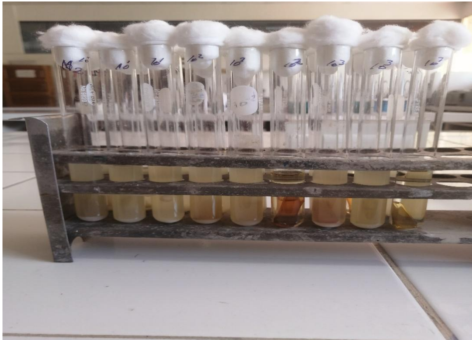
Figura 55. Determinación de Coliformes totales NMP/100 ml, muestra M1-1 y M2-1 (sin presencia).
