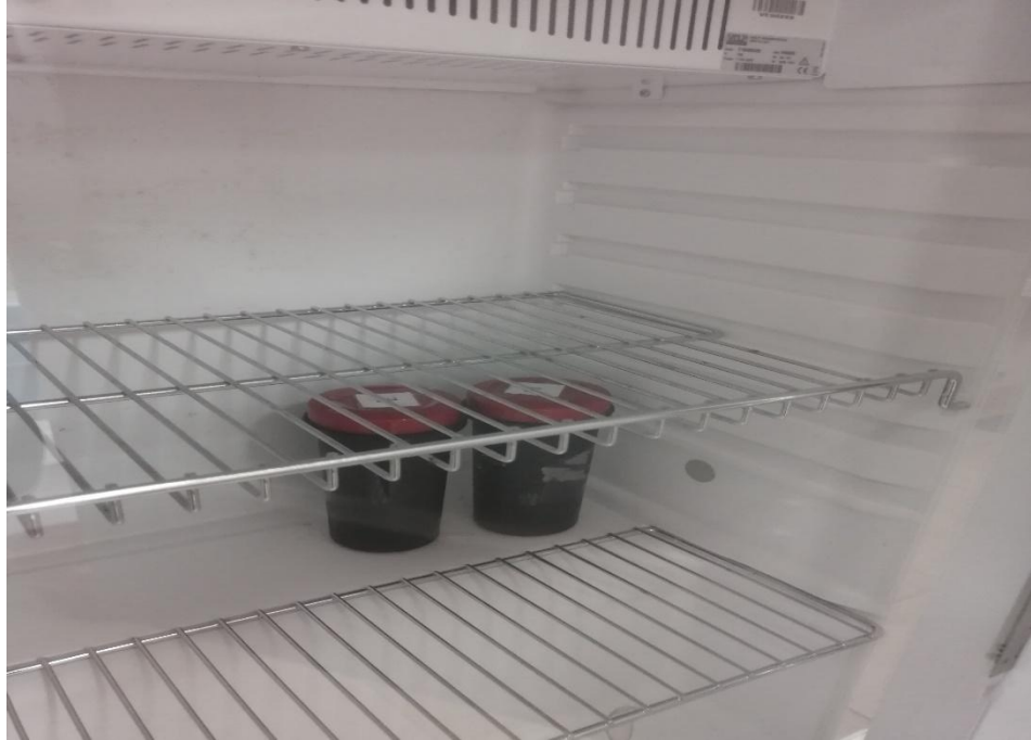
Figura 54. Muestras en la cámara de incubación para la determinación de DBO5.
