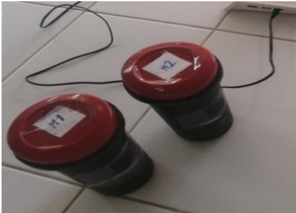
Figura 51. Muestras para determinación de O.D y DBO5.
