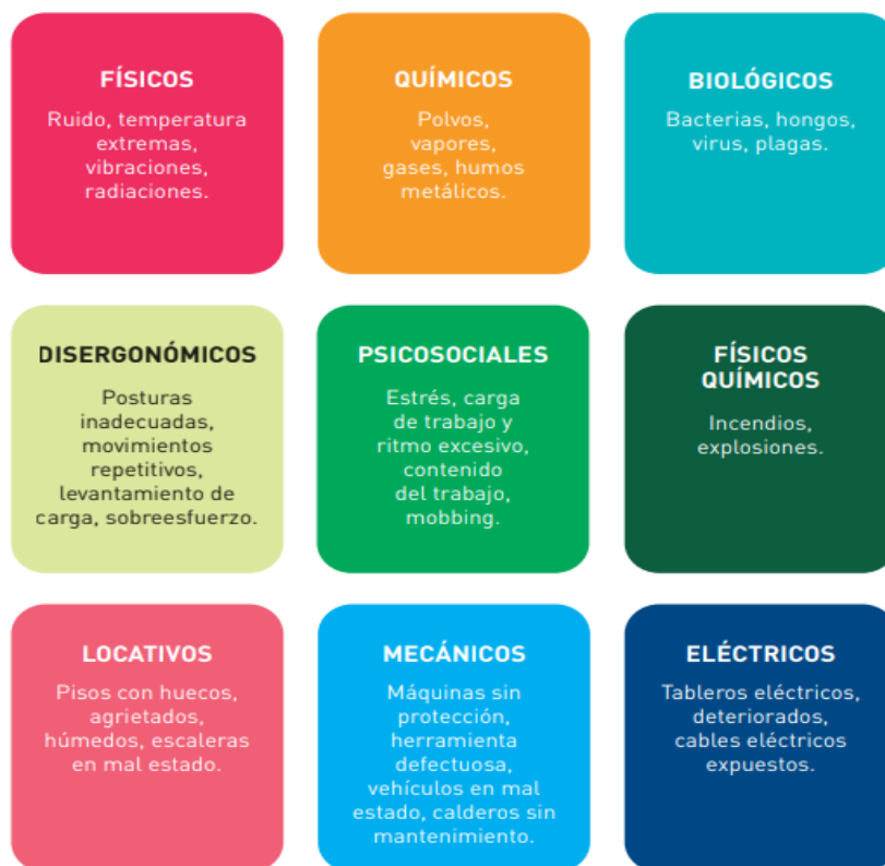
Figura 1. Categorización de peligros
