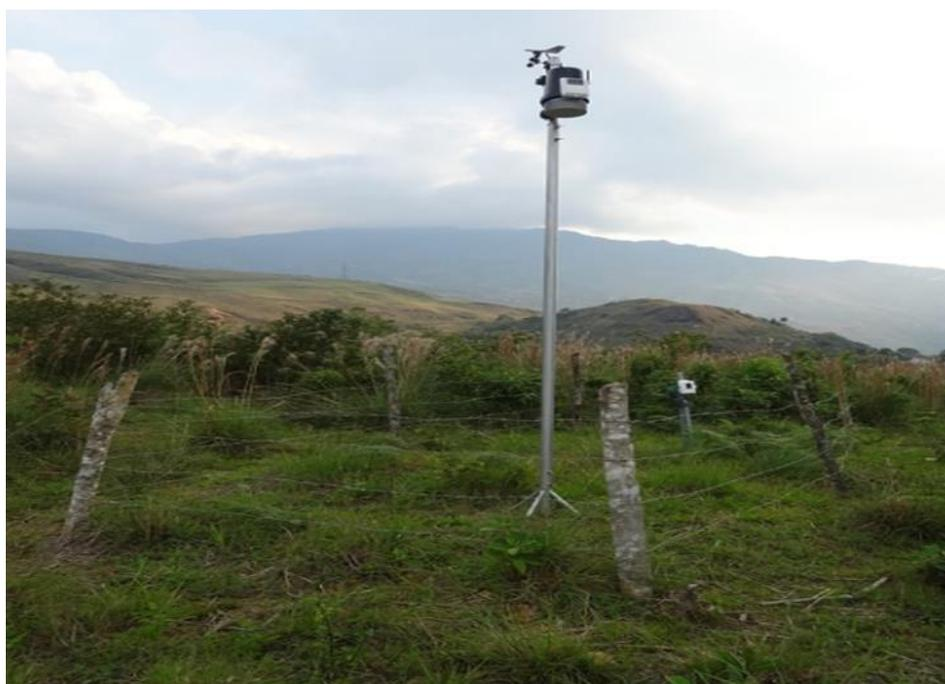
Figura 40. Estación meteorológica automática challan
