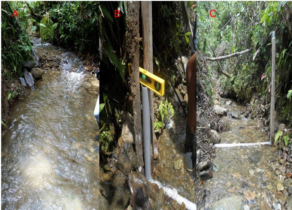
Figura 34. Zona de aforo en la cuenca: A (Quebrada challana), B (Instalación y nivelación del equipo), C (Equipo instalado)
