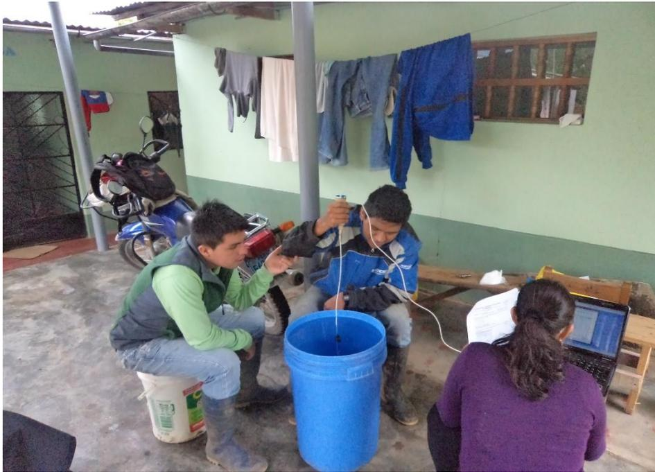
Figura 33. Calibración del sensor de nivel de agua ODISEY
