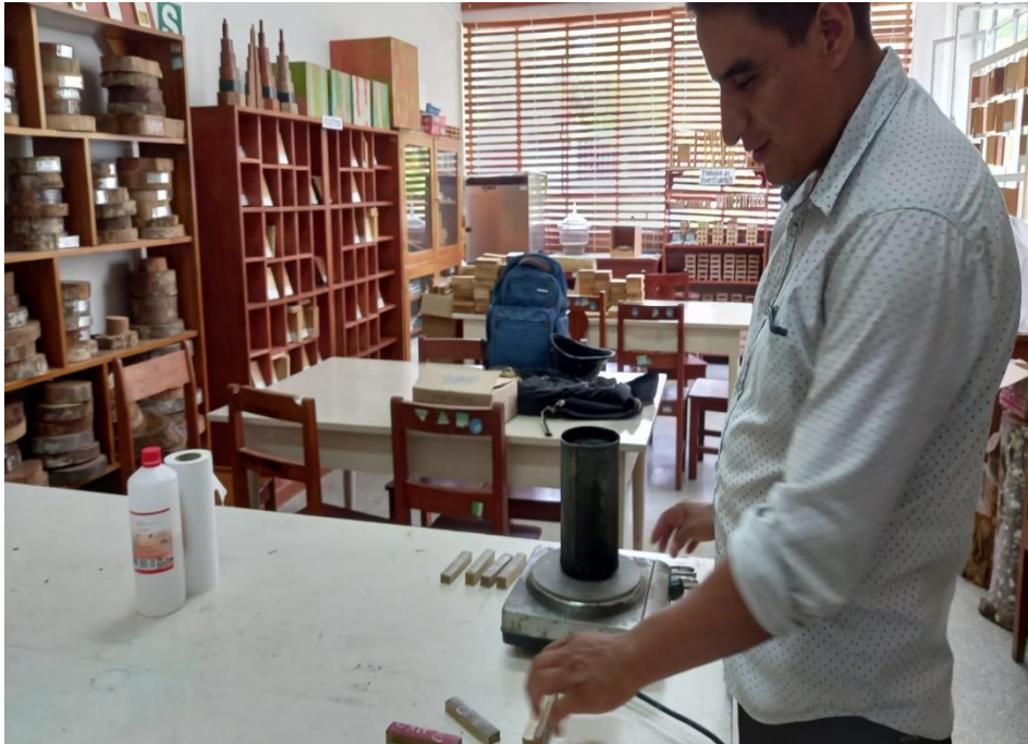
Figura 30. Parafinado de probetas de D. asper
