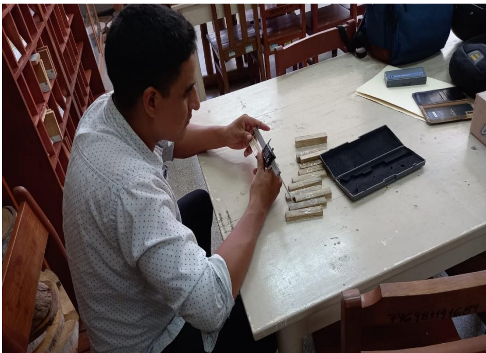
Figura 29. Medición de las secciones longitudinales de probetas de D. asper
