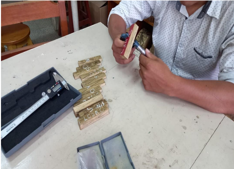
Figura 28. medición de las secciones tangenciales y radiales de probetas de D. asper
