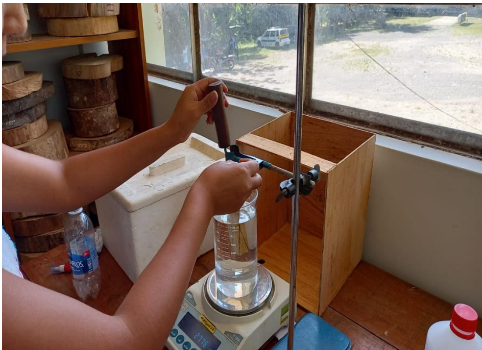
Figura 27. Volumen de probetas por principio de Arquímedes
