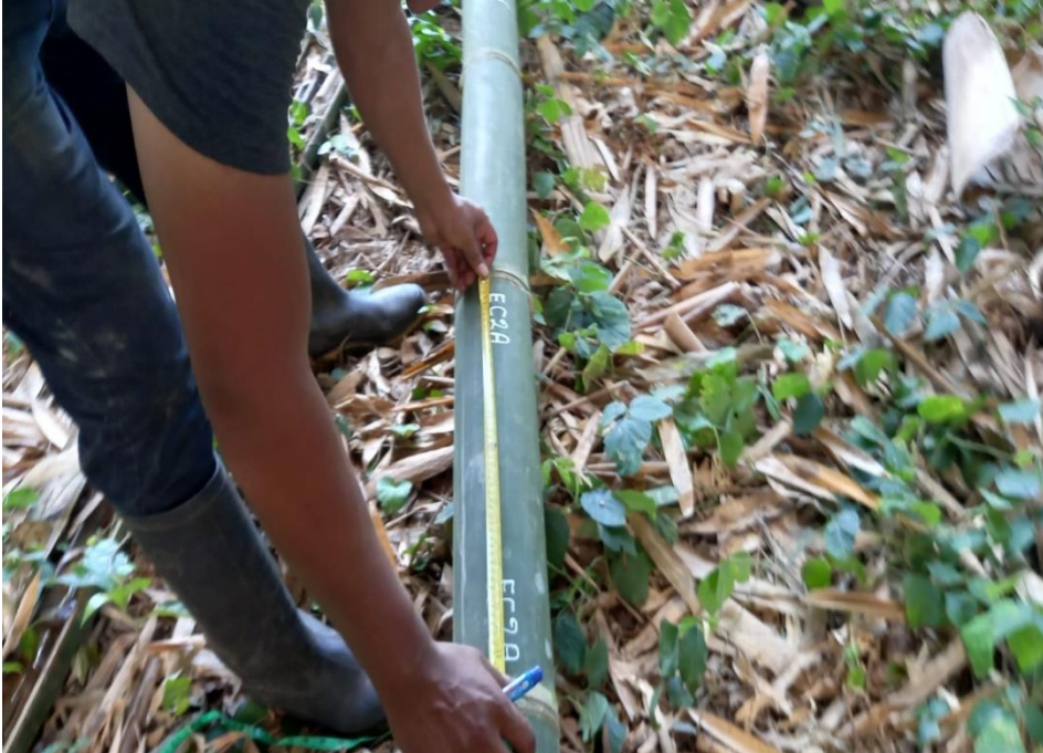
Figura 22. medición de longitud de internodos
