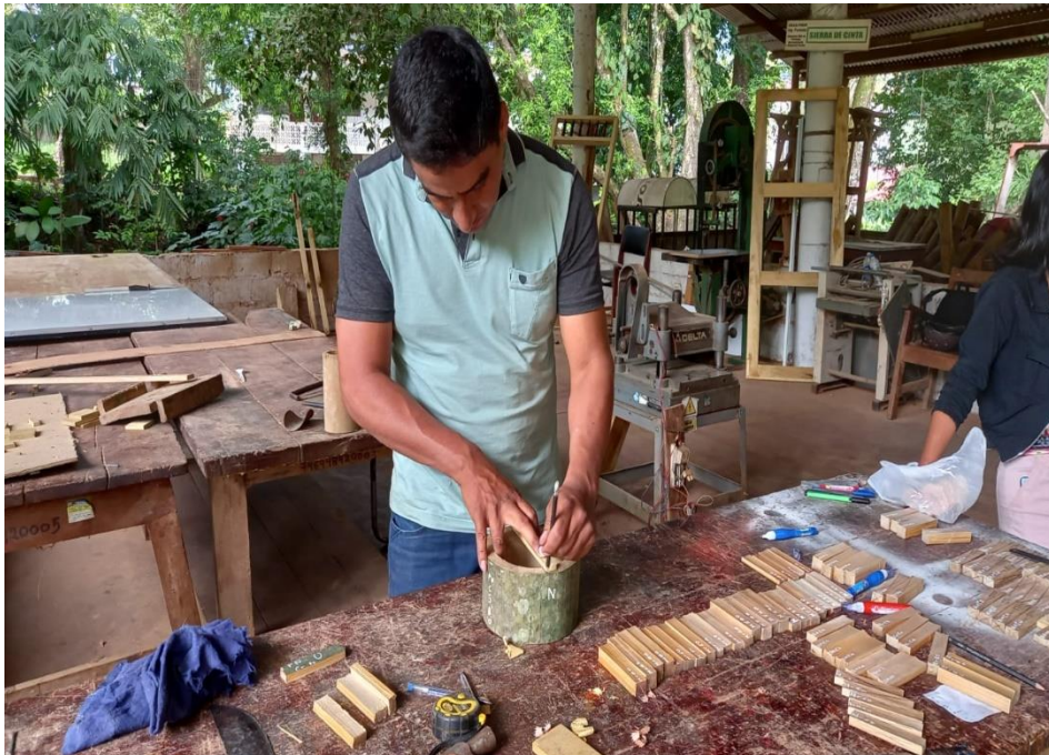
Figura 25. Obtención de probetas para ensayos físicos
