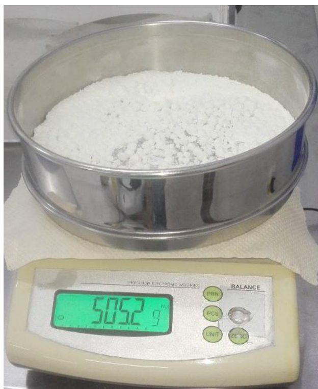
Muestra pesada para determinar el índice de finura
