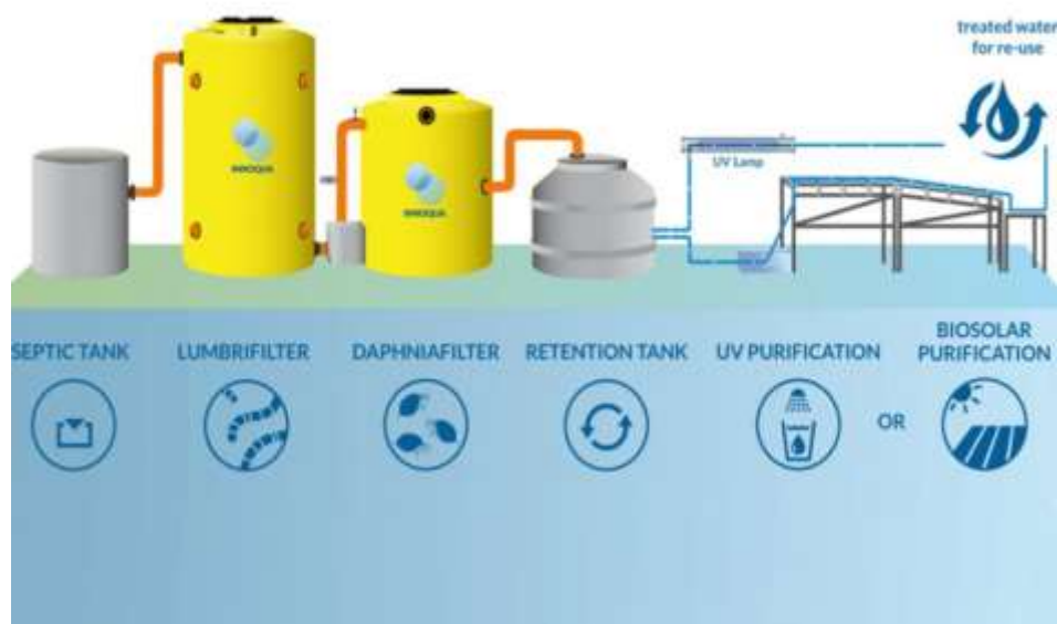
Figura 3. Sistema de tratamiento desarrollado por la UCSM
