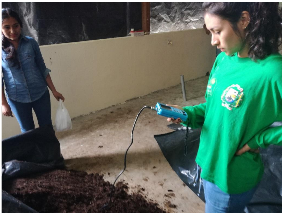
Figura 10. Midiendo la temperatura de otra pila de compost en la planta de compostaje.
