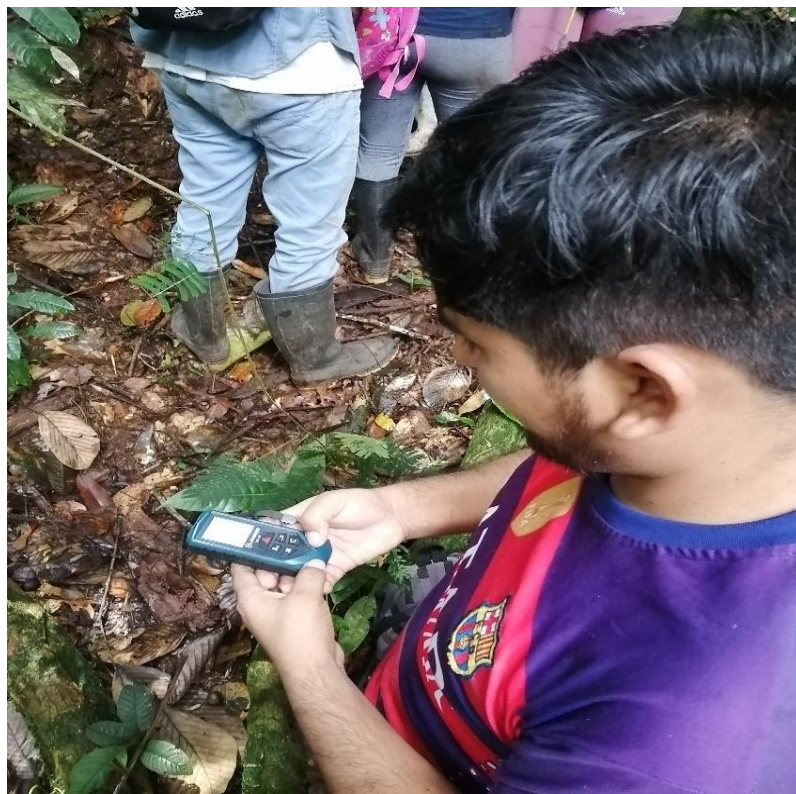
Figura 14. Medición de la distancia del árbol a un punto conocido para calcular la altura, usando distanciómetro láser.
