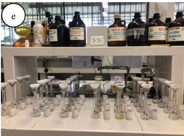
Figura 23. Determinación de microelementos: a. Pesado de muestra, b. Cocinado de muestras en mufla, c. Filtrado de muestras, d. Digestión en cocina, e. Filtrato y f. para lectura en espectrofotómetro
