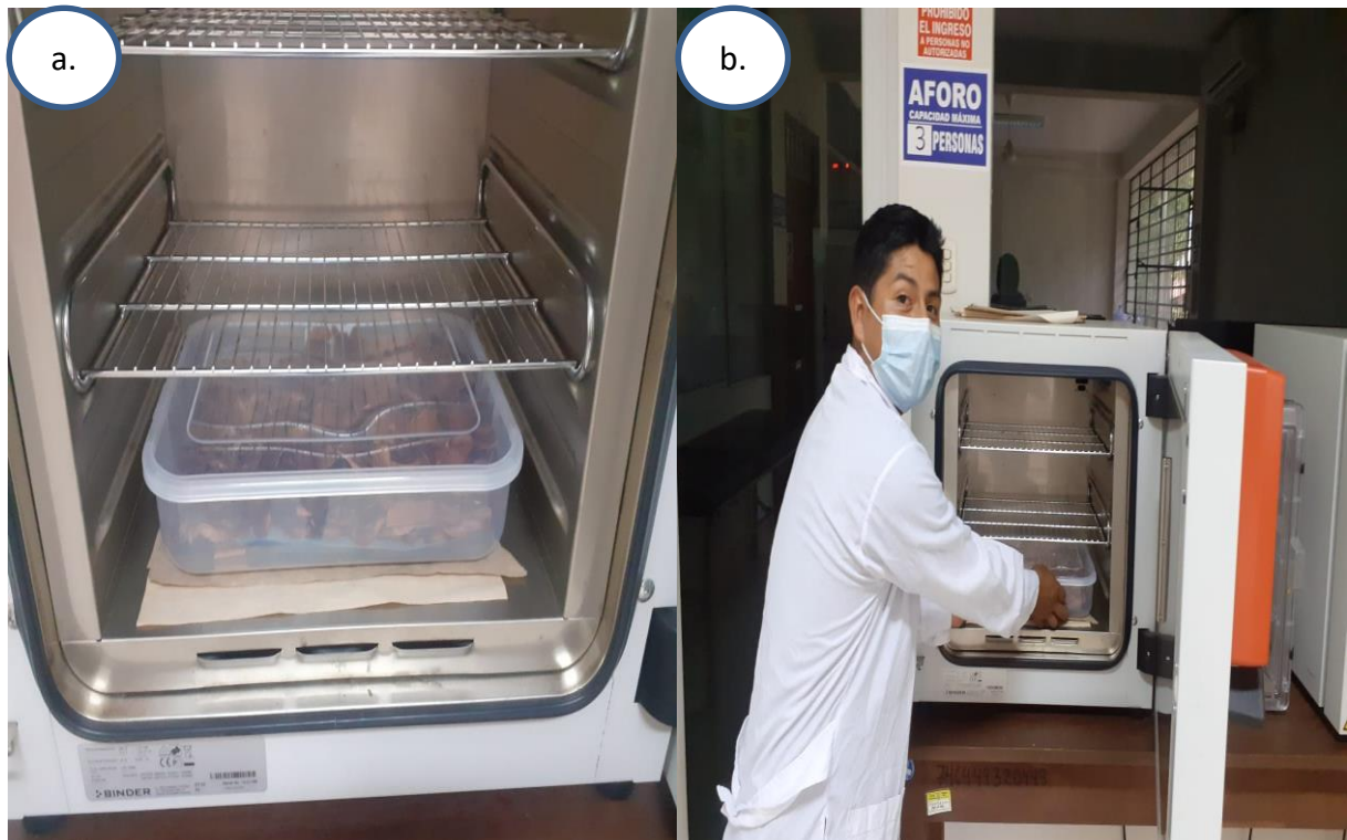
Figura 2. Prueba de envejecimiento acelerado: a. Estufa con semillas acondicionadas. b. Retiro de las semillas de la estufa.
