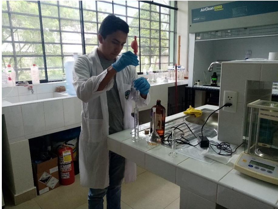
Figura 15. Preparación de 10 ml del ácido nítrico y 40 ml de alcohol para agregar a un balón de 250 ml con la muestra para la determinación de celulosa.
