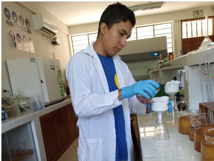
Figura 22. Filtración del contenido de lignina sobre un embudo Buchner provisto de dos filtros superpuestos
