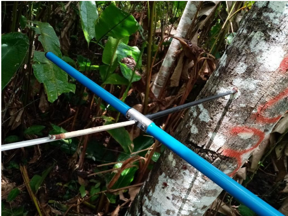
Figura 8. Recolección de la muestra con la ayuda del taladro de Pressler
