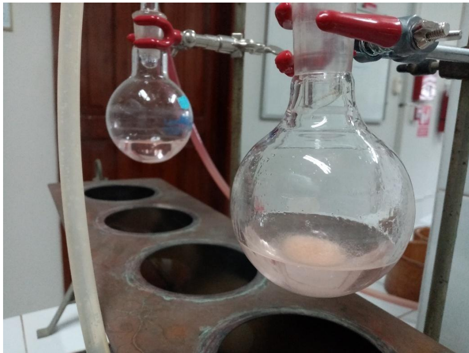
Figura 16. Ebullición de la muestra con ácido nítrico y alcohol en el balón de 250 ml para la determinación de celulosa
