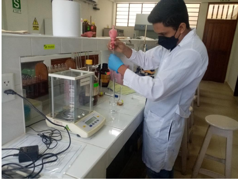
Figura 13. Preparación de la concentración de los ácidos para la determinación de celulosa y lignina.
