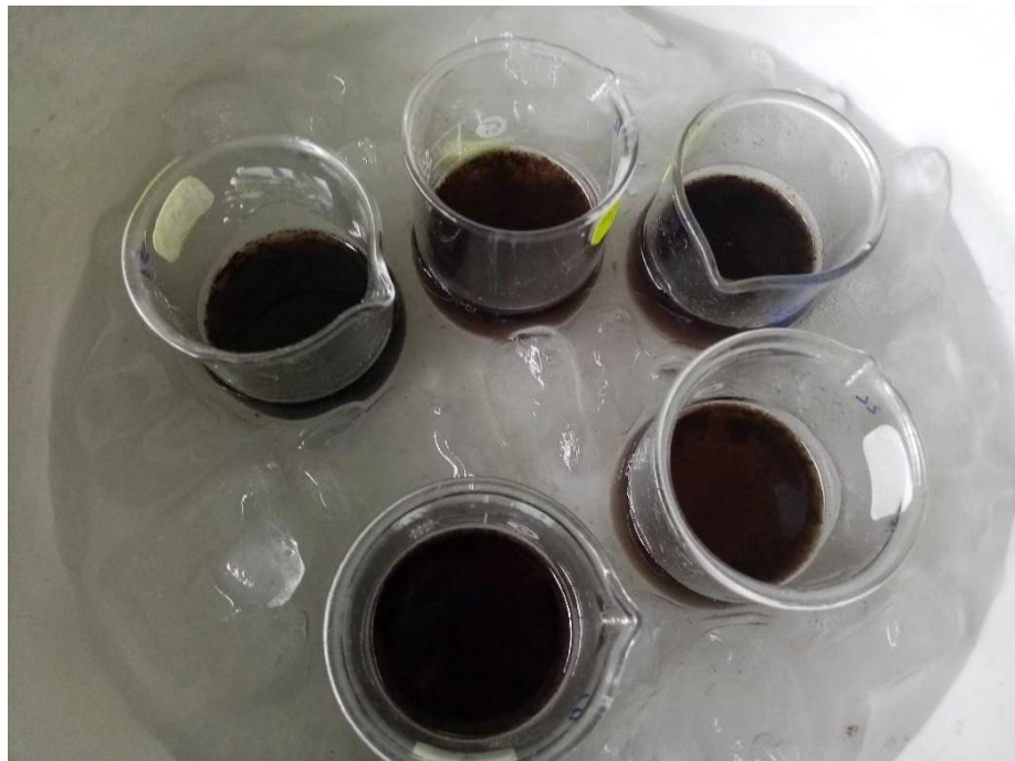
Figura 20. Enfriamiento de mezcla homogénea (muestra seca + ácido sulfúrico( H_2SO_4 ) al 72 %) en agua y hielo para la determinación de lignina
