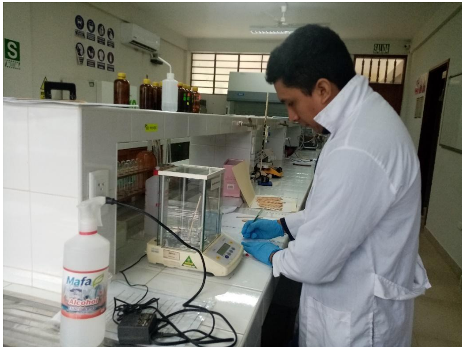
Figura 10. Pesado de las muestras recolectada para la determinación de fracción de masa seca (k).
