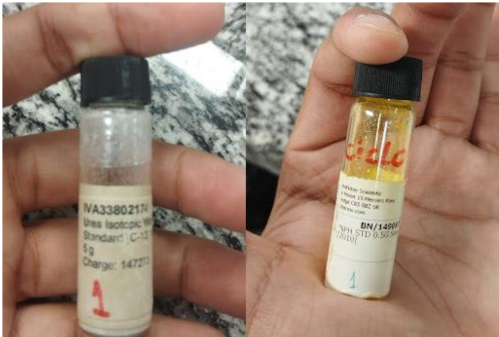
Figura 17. Patrones estándar para la calibración del equipamiento de análisis isotópico (patrón de trabajo isotópico de urea C-13, N-15-5g y ciclohexanona)
