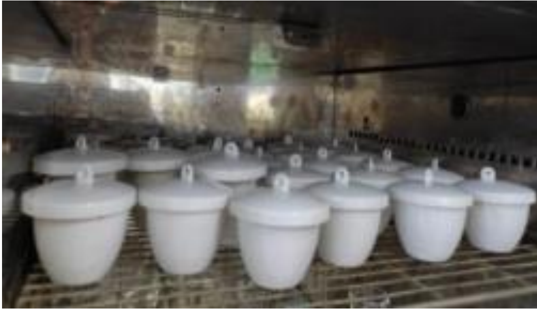
Figura 11. Muestras en crisol de porcelana y dentro de la estufa
