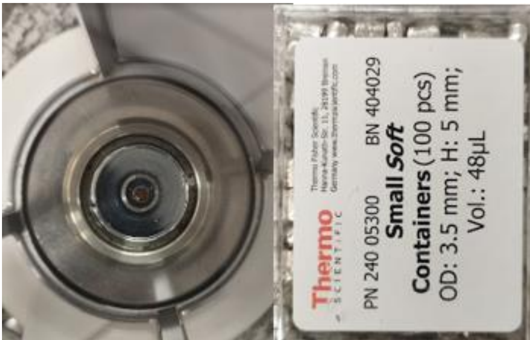
Figura 16. Muestra de suelo dentro de la micro balanza y las capsulas de estaño utilizadas
