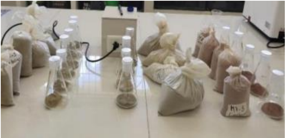
Figura 9. Muestras de suelo pesadas y codificadas
