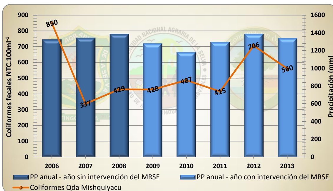
Figura 5. NTC.100lm -1 de coliformes fecales presentes en el agua de la zona de captación de la quebrada Mishqiyacu vs precipitación acumulada (2007 – 2014)
