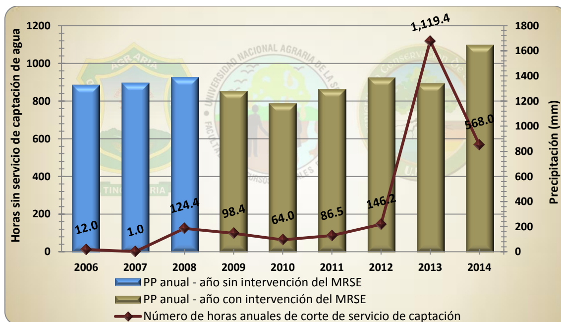
Figura 16. Número de horas de corte del servicio de captación de agua por problemas de turbidez en la quebrada Mishqiyacu versus la precipitación acumulada (2006 – 2014)
