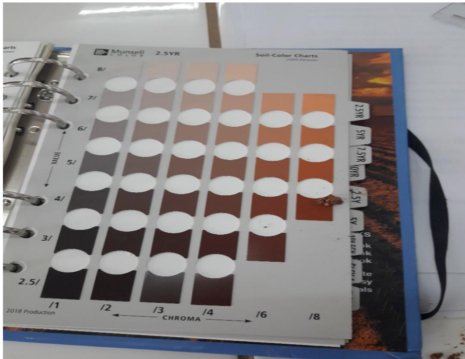
Figura 37. Prueba para la determinación del color del suelo en la tabla Munsell
