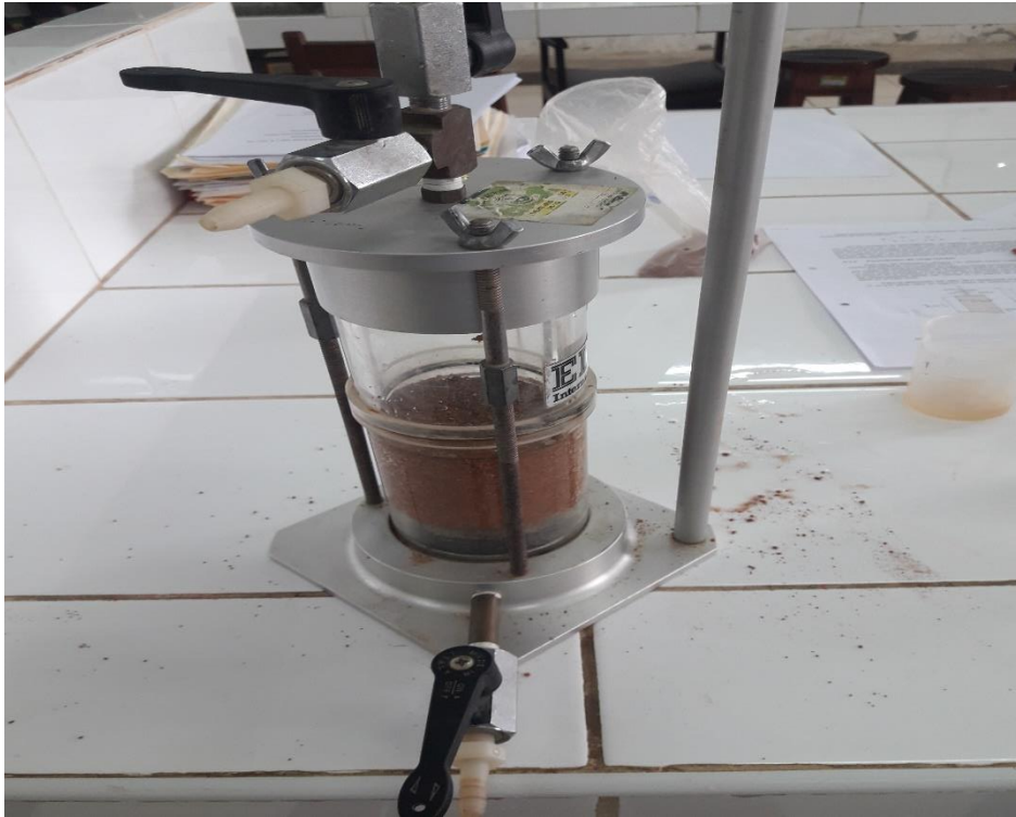
Figura 36. Prueba de la permeabilidad y conductividad hidráulica del suelo
