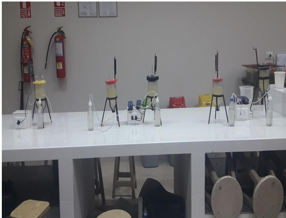
Figura 27. Inicio del proceso de operaciones en los biorreactores
