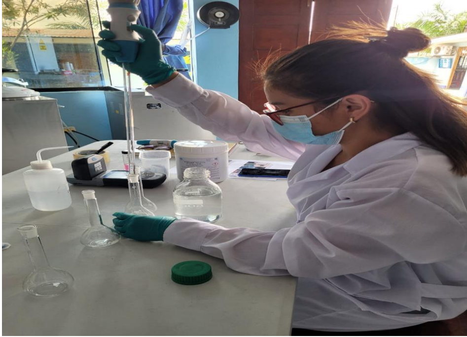
Figura 16. Realizando la demanda de cloro del agua cruda del sistema
