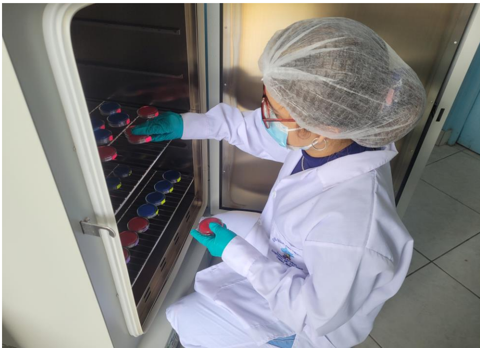
Figura 27. Colocando las muestras de coliformes termotolerantes y Escherichia coli en la incubadora a 44.5°C
