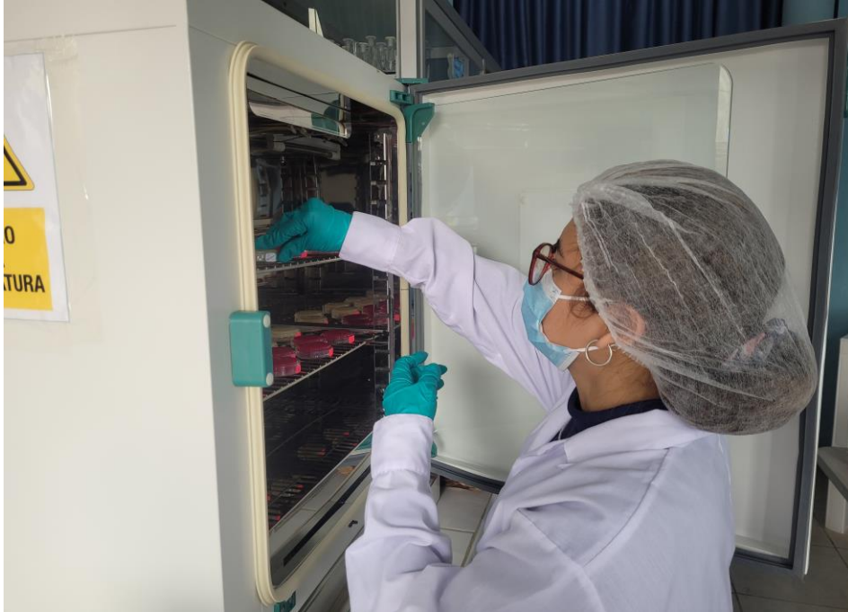
Figura 28. Depositando las placas Petri con las muestras de bacterias heterotróficas y coliformes totales en la incubadora a 35°C
