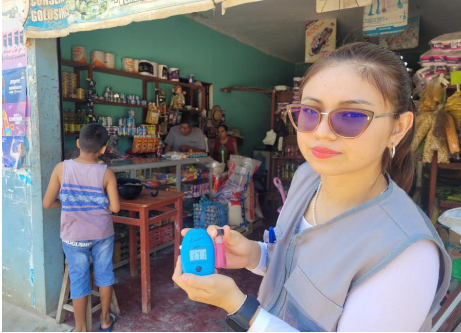
Figura 38. Medición final de cloro libre en la red de distribución
