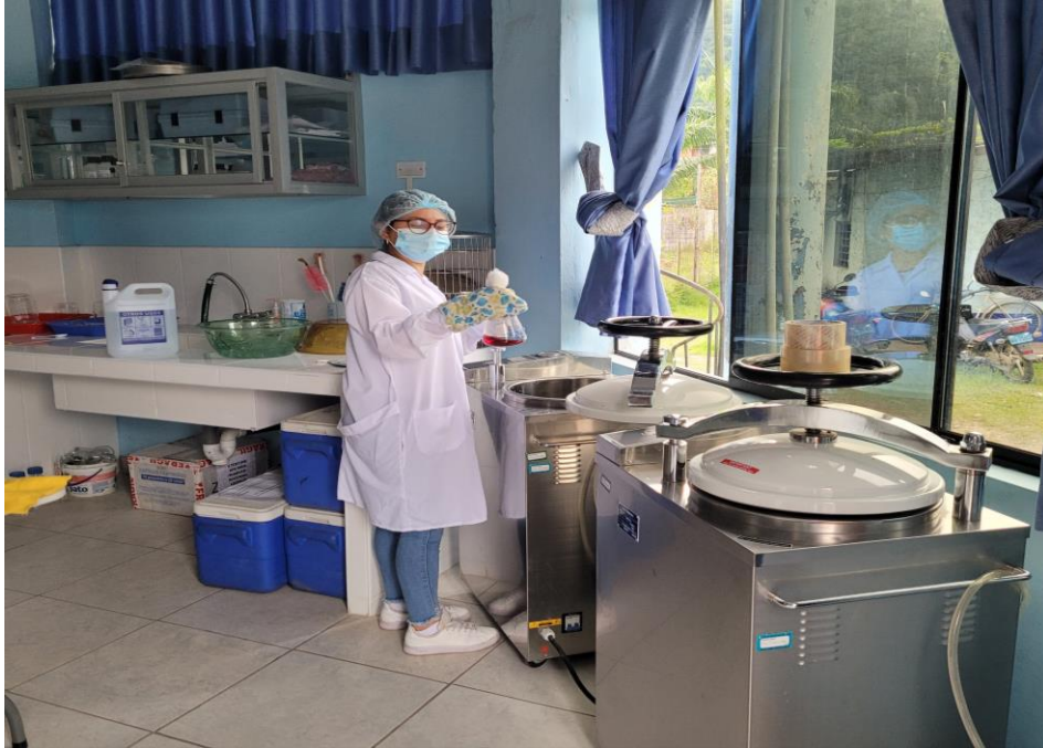
Figura 24. Diluyendo los agares Plate Count Agar y Macconkey Agar para bacterias E. coli y Heterotróficas en la autoclave respectivamente
