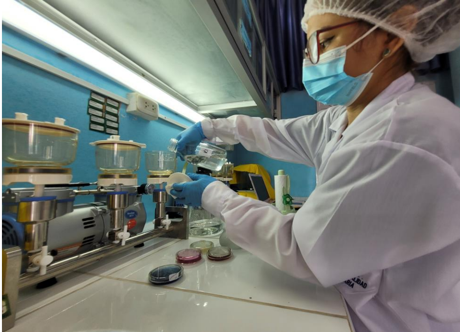
Figura 26. Vertiendo 100 ml de muestra de agua en el embudo de filtración del equipo de filtración al vacío
