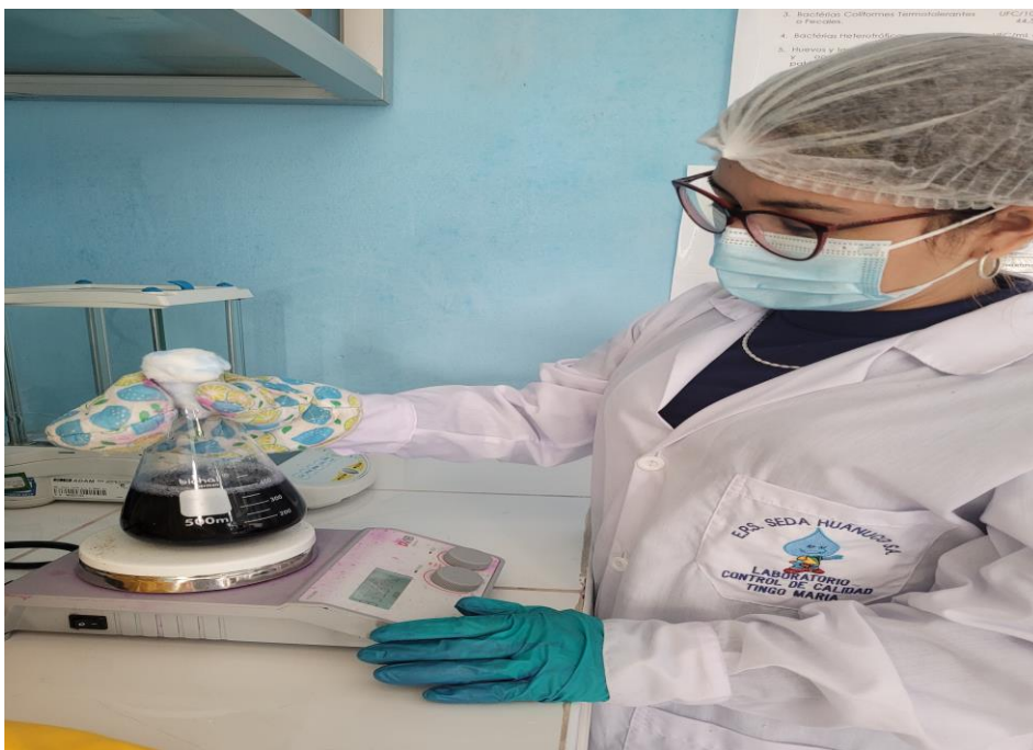
Figura 23. Diluyendo los agares de M-Fc Agar Base y M-Endo Agar para bacterias coliformes totales y termotolerantes en el agitador magnético respectivamente
