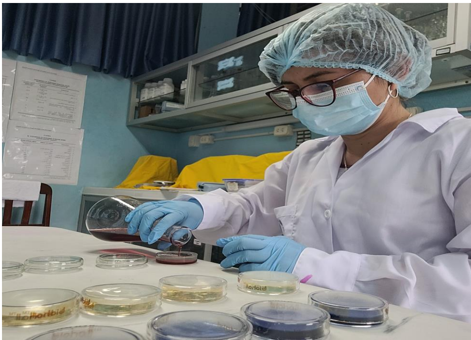
Figura 25. Depositando las soluciones disueltas de cada agar en las placas Petri
