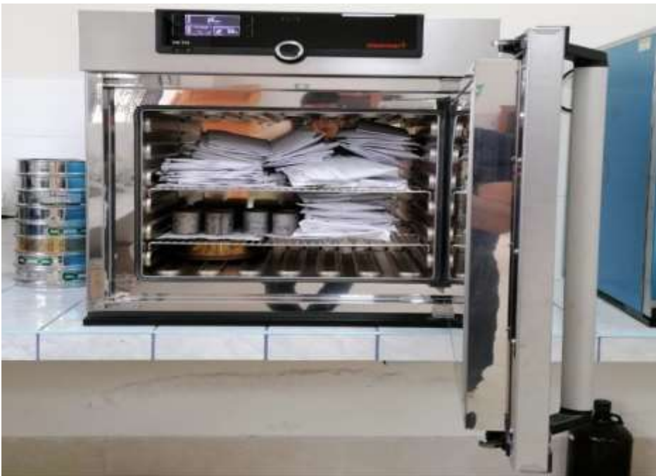
Figura 16. Secado de muestras de biomasa en estufa del laboratorio
