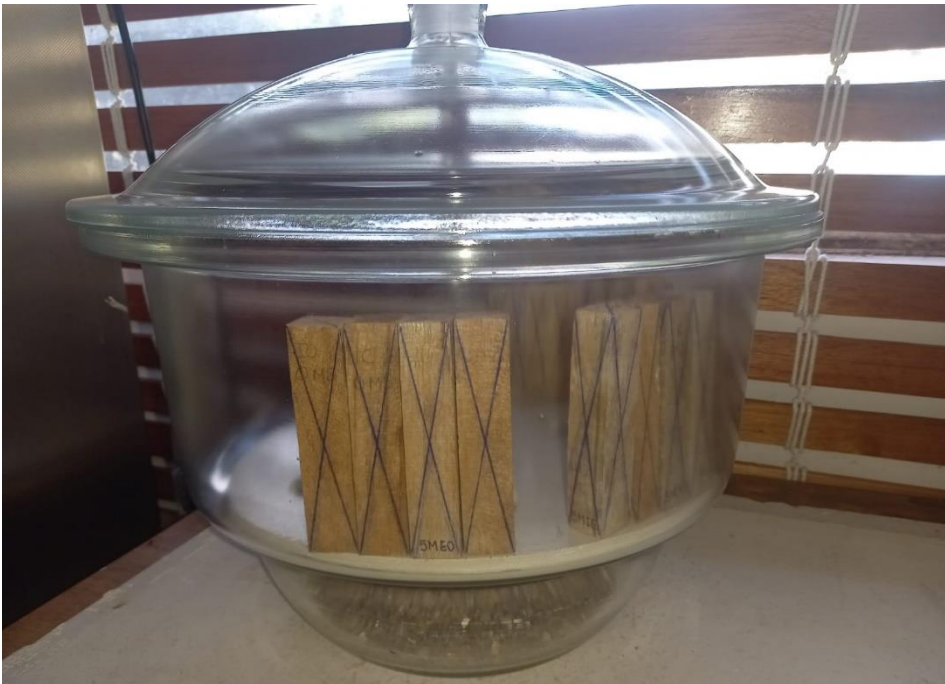
Figura 40. Probetas en el desecador, posterior de haber sido retirados de la estufa.
