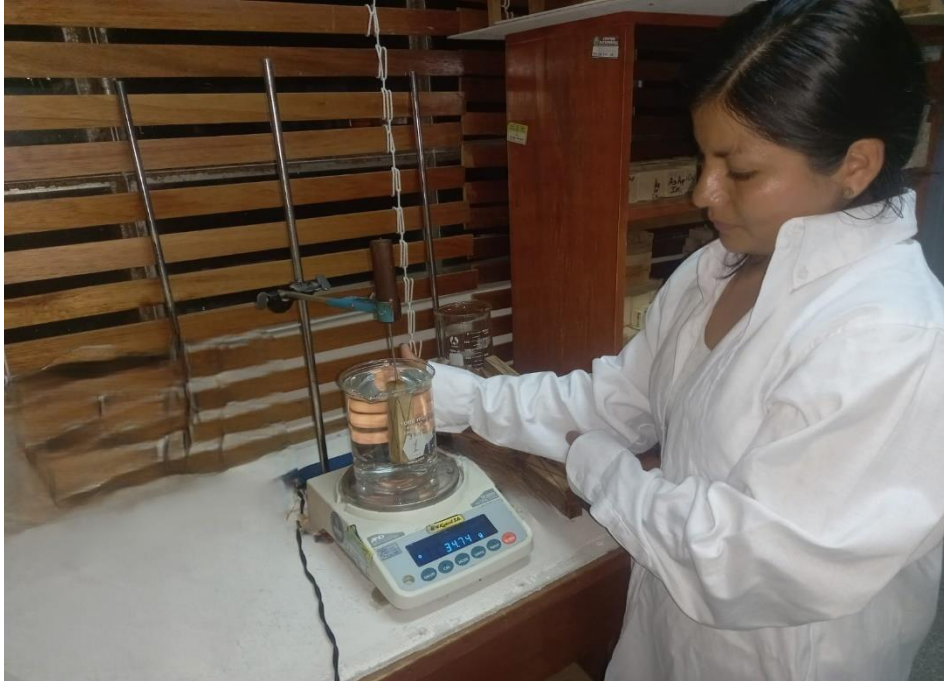
Figura 43. Evaluación del volumen a través del principio de Arquímedes.
